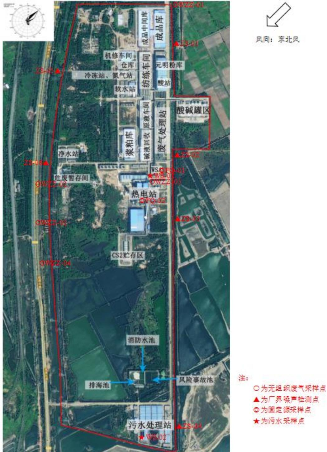
图 7.4-1 废气、噪声监测点位示意图
